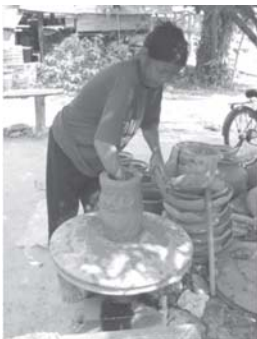
การขึ้นรูปภาชนะบนพะมอน
