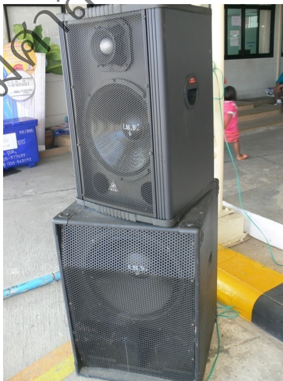
ตู้ลำโพงที่ใช้สำหรับซ้อมและการแข่งขัน ตู้ลำโพงเสียงกลางแหลม ขนาดลำโพง 15 นิ้ว ตู้ ลำโพงเสียงเบสหน้าเปิดขนาด 15 นิ้ว
